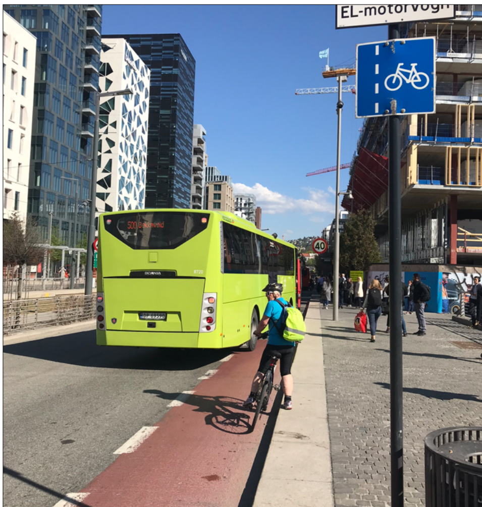
Figur 1-3 Holdeplassløsning av typen sykkelfelt som opphører ved bussboks der en syklist må vente på en buss som skal til å stoppe for på- og avstigning. Foto: Asplan Viak.
