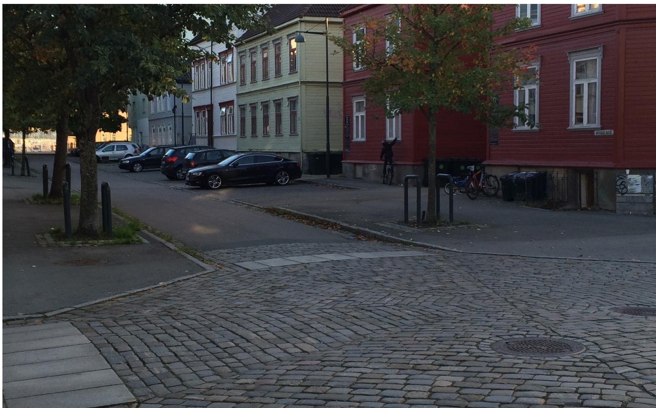
Foto 18: I Trondheim snevres gaten inn ved hjelp av ekstra møbleringssone med beplantning (foto: Urheim.).
