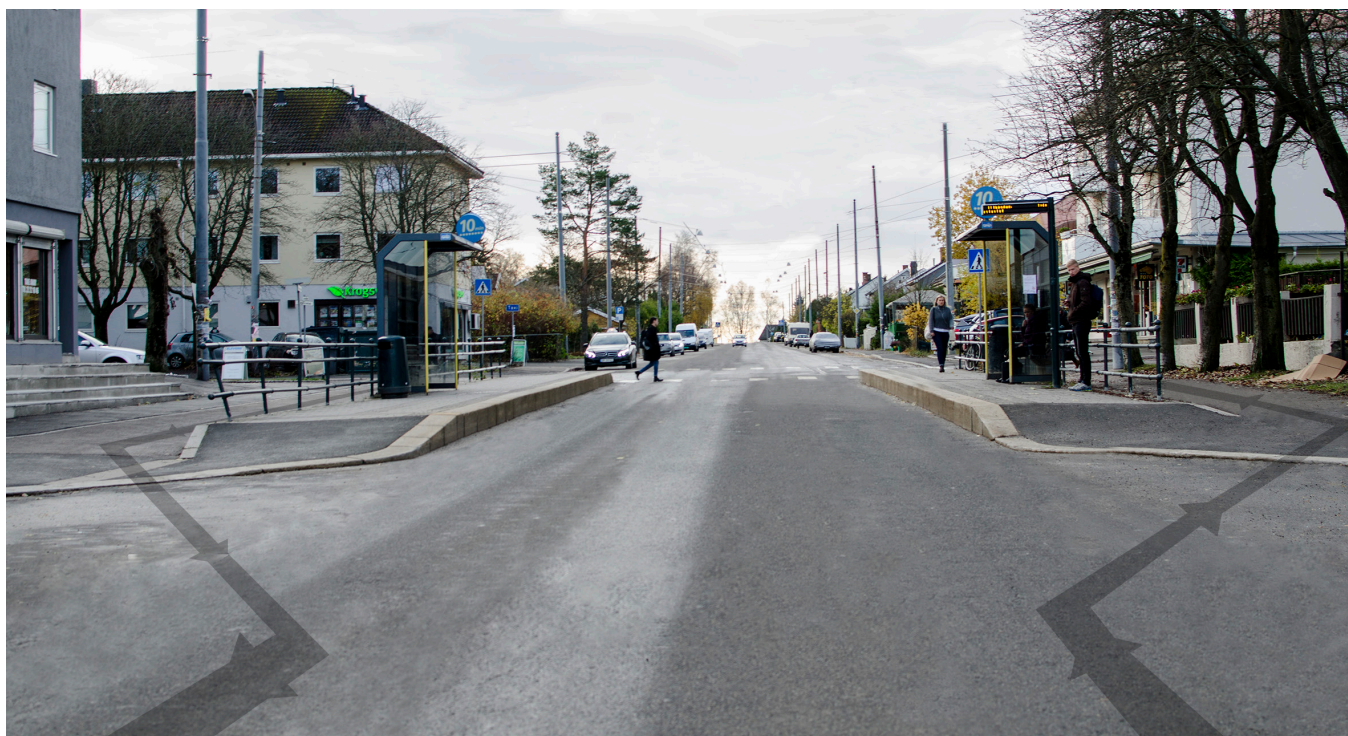
Foto 31: En tilpasning med nedsenket kantstein som gjør det mulig for syklende å passere bak holdeplass over fortau gir et trygt alternativ for dem som ikke vil sykle forbi buss eller trikk ved holdeplass. (foto: Borge.).
