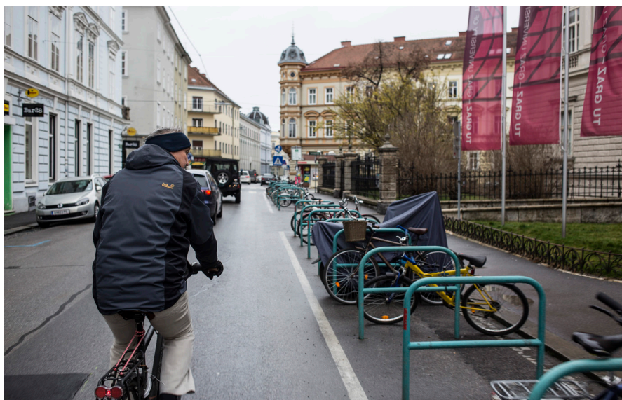
Foto 38: Ved Technische Universität Graz er sykkelparkering plassert like ved hovedinngangen i naturlig forlengelse av sykkelveien. Stativene, som kalles for "Sheffield Stand", er funksjonelle for ulike sykler (foto: Copenhagenize Design Co.).
