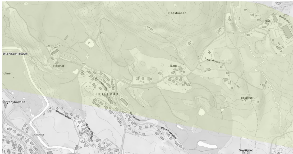
Figur 1 Kartet viser området tunnelboremaskinen har tillatelse til å bore i. Selv om området er ganske bredt er selve tunnelen bare i overkant av 5 meter bred. Tunnelboremaskinen befinner seg nå på venstre side av kartet og borer østover mot Oslo.
