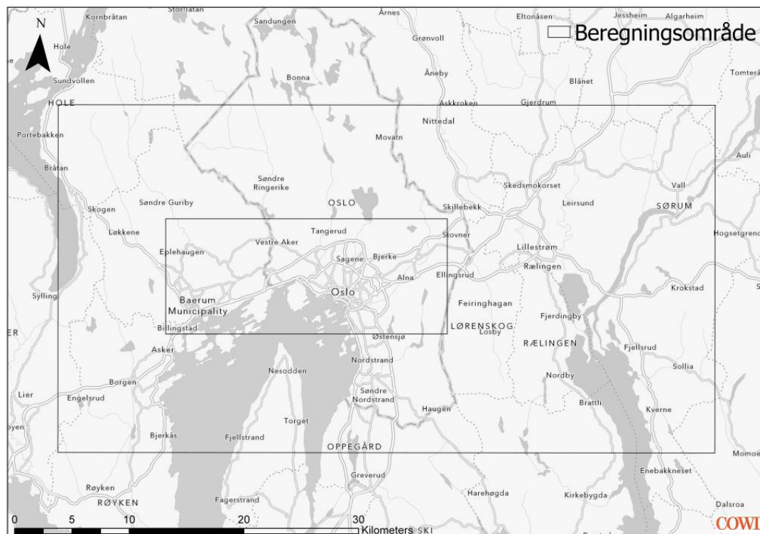
Figur 1 De to områdene som er anvendt i spredningsberegningene. Det største området har en oppløsning på 300 x 300 meter, området innenfor den mindre svarte rammen har en oppløsning på 50 x 50 meter. Kilde: COWI.
