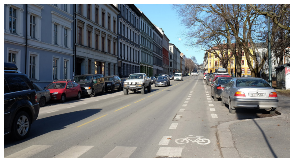
Figur 23: Bildet viser sykkelfelt i Toftes gate, uten buffersone mot parkering.
