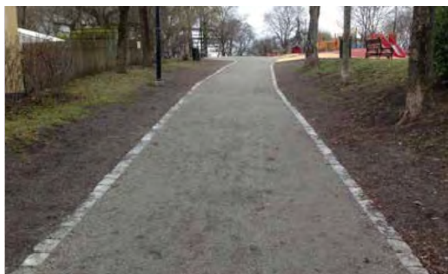
Naturlig ledelinje, med kontrast mellom kantstein og grusvei. Foto: Jan Tore Lindskog, Omsorgsbygg. Oslo KF.
