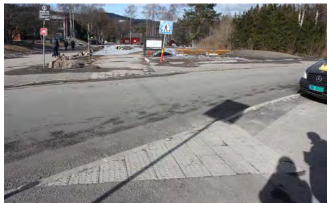
Varselfelt uten ledelinje: Fullstendige ledelinjer og opphøyd gangfelt kan gi et tydeligere hierarki og en tryggere situasjon ved innkjøring til P-plassen.
