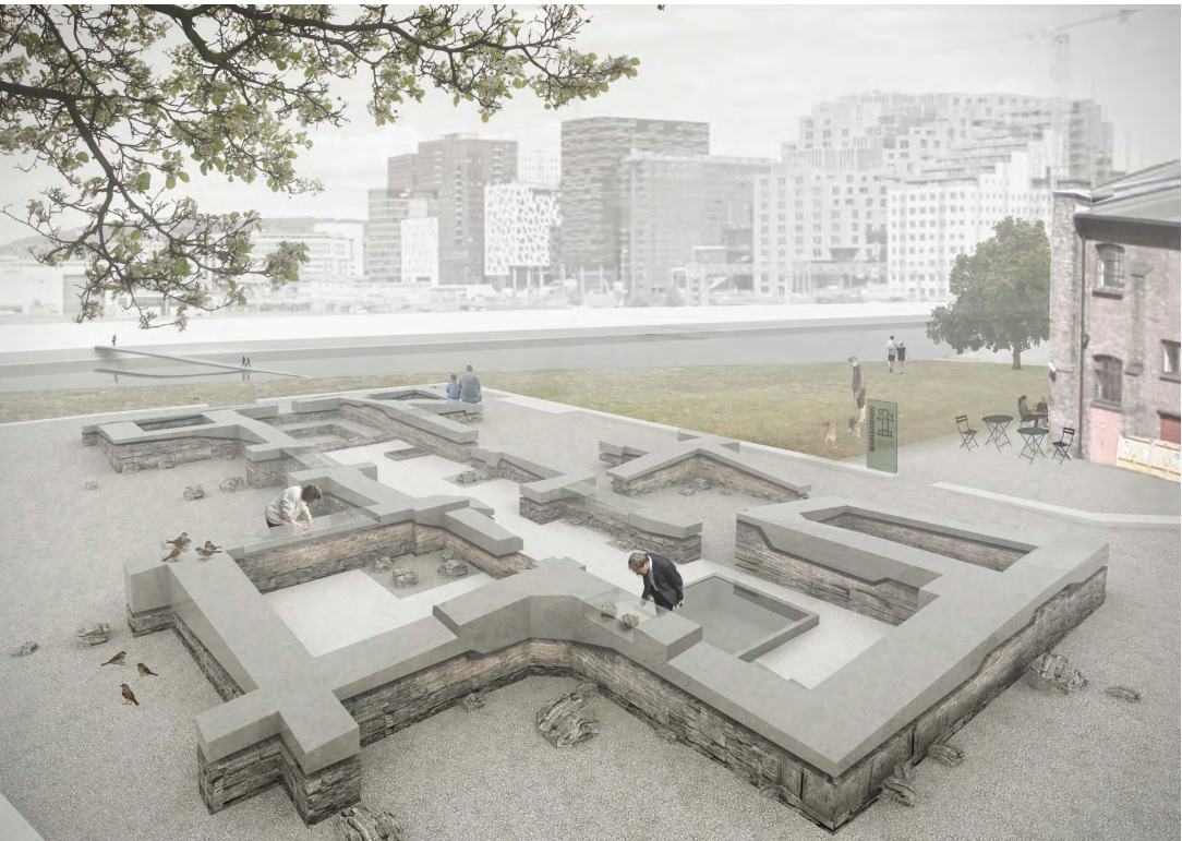
Mariakirkeruinen med betongdekke inni. Illustrasjonen viser ruinbeskyttelse med sy- refast stål, som ikke er en aktuell løsning.
