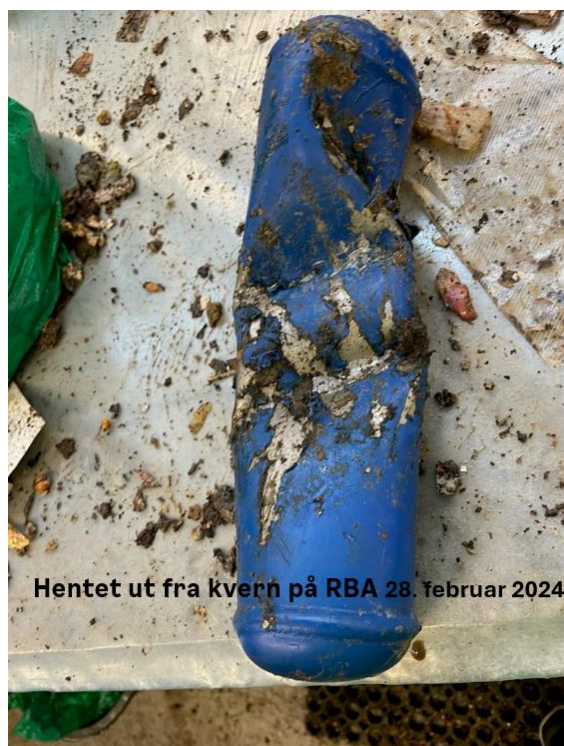
Figur 25 Romerike biogassanlegg (RBA): Funn av flasker som har satt seg fast i kvern, skruetransportør
