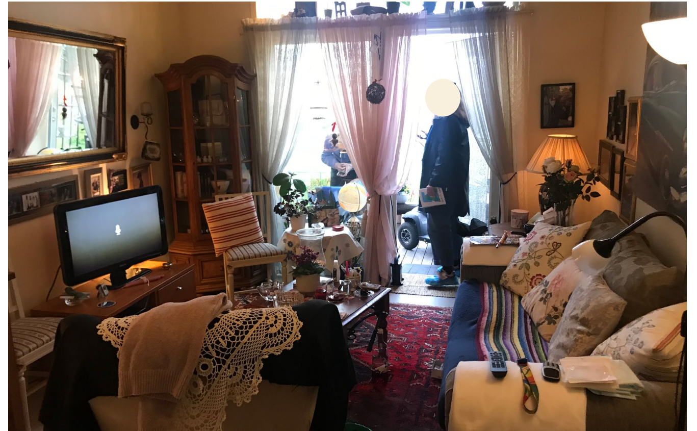
Bilde av en beboerleilighet fra en av befaringene. På bildet ser vi et eksempel på hvordan hovedinngangen til leiligheten er rett inn i oppholdsrommet fra uteområdet, uten en ordentlig entré. Eneste mulighet beboer har for å få frisk luft inn i leiligheten, er ved å åpne inngangsdøren. Dette føltes utrygt for beboer. Tilnærmet hele endeveggen til leiligheten er dekket av glassareal, som beboer syntes var unødvendig stort og skapte utrygghet, da beboer har opplevd flere ubehagelige situasjoner utenfor inngangsdøren sin.
