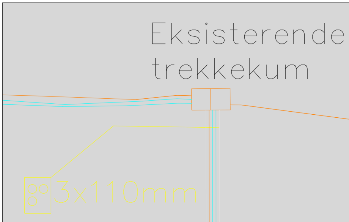
Figur 15-1: Eksempel fra fil med innmålingsdata. Innmålt trekkeikum er tydelig vist som eksisterende. Informasjon om trekkerør i kanal er vist med gul snittboks.
