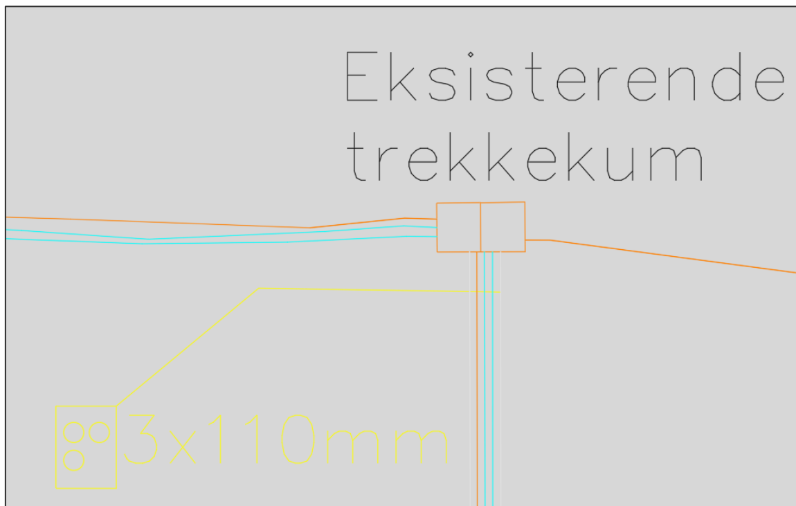
Figur 15-1: Eksempel fra fil med innmålingsdata. Innmålt trekkerekum er tydelig vist som eksisterende. Informasjon om trekkerør i kanal er vist med gul snittboks.
