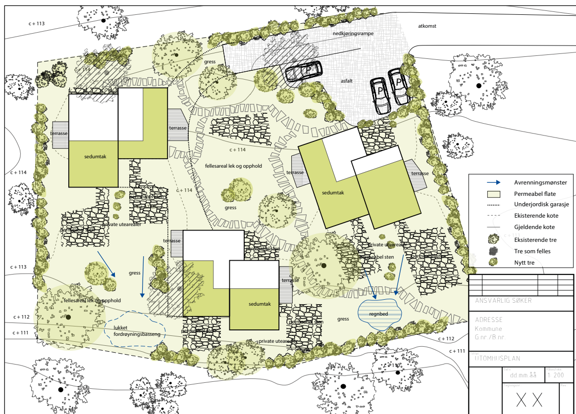
Fig. 5.2 Eksempel på utomhusplan, flere enn 5 boenheter. Overvannshåndtering i form av lukket fordrøyning, regnbødd og grønne tak. Planen viser også eksisterende og planlagt terreng, gangareal, felles og privat uteoppholdsareal, lekeareal, parkeringsareal, eksisterende trær som skal bevares/felles og ny vegetasjon.
