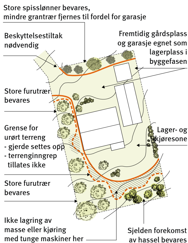
Fig.20.2 Eksempel på marksikringsplan.
