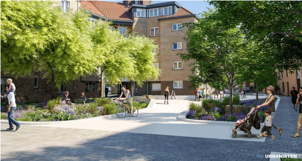
Figur 48. Vanntorg slik det er foreslått av De Urbanisten, med regnbed som mottar vann fra takene og flatene i nærheten. Det er viktig at plassen fungerer ved oppholdsvær og ved nedbør.
