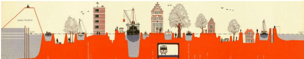
Figur 1. En betydelig del av Nederland ligger under havets overflate. Dette gir en komplisert og avansert form for byutvikling. All nedbør som ikke fordampes må pumpes ut (Slide fra D. Goedbloeds foredrag).
