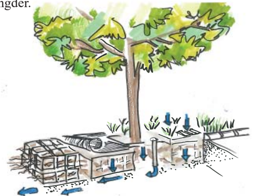
Cellemoduler av plast legges omtrent som legoklosser. På begrenset plass gir de mulighet for å plante flere trær.
