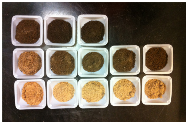
Filtermedium-prøver for analyse av forurensning. Hver prøve representerer et segment (2,5 cm) av en vertikal prøve tatt fra regnbede. De mørkeste prøvene er tatt nær overflaten og inneholder mye organisk materiale og også avstand fra overflaten. Mesteparten av forurensningen ble funnet i topplaget.
