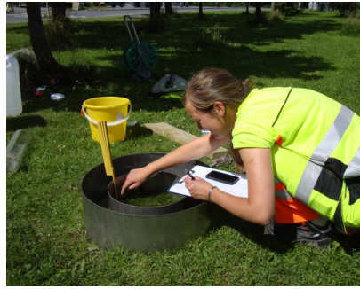
Figur 3: Forsøk med dobbelring-infiltrometer. Ytre og indre ring fylles samtidig med vann etter at ringene er banket 5-10 cm ned i bakken (bilde 1). Vannhøyde (indre ring) og tilhørende tid noteres etter hvert som vannet infiltrerer (bilde 2). På byggegrunn er det utfordringer med å få dobbelringen ned i bakken, men en murskje eller kniv er et fint verktøy for å fjerne stein som ligger i veien, før ringene bankes ned (bilde 3).
