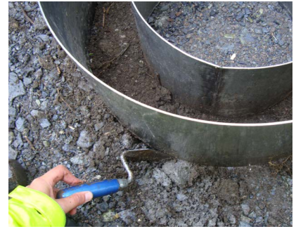
Figur 3: Forsøk med dobbelring-infiltrometer. Ytre og indre ring fylles samtidig med vann etter at ringene er banket 5-10 cm ned i bakken (bilde 1). Vannhøyde (indre ring) og tilhørende tid noteres etter hvert som vannet infiltrerer (bilde 2). På byggegrunn er det utfordringer med å få dobbelringen ned i bakken, men en murskje eller kniv er et fint verktøy for å fjerne stein som ligger i veien, før ringene bankes ned (bilde 3).
