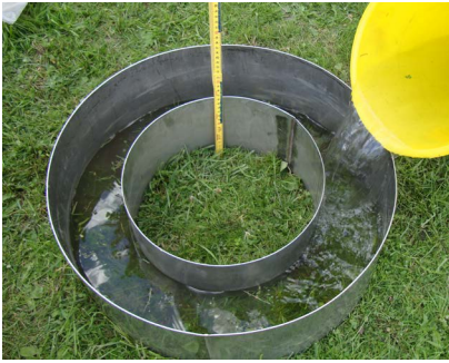
Figur 3: Forsøk med dobbelring-infiltrometer. Ytre og indre ring fylles samtidig med vann etter at ringene er banket 5-10 cm ned i bakken (bilde 1). Vannhøyde (indre ring) og tilhørende tid noteres etter hvert som vannet infiltrerer (bilde 2). På byggegrunn er det utfordringer med å få dobbelringen ned i bakken, men en murskje eller kniv er et fint verktøy for å fjerne stein som ligger i veien, før ringene bankes ned (bilde 3).
