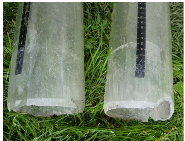
Figur 5: MPD - rørene er spisset på utsiden slik at jorda inne i røret blir mest mulig uforstyrret. Steinholdig grunn kan ødelegge rørene. Bruk kniv langs ytterkanten på røret før det bankes ned.
