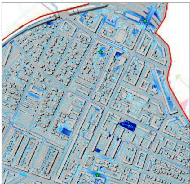
Skybruddskart med modell av strømningsveier og oppstuvning av vann på terreng i et delområde i København ved en klimafremskrevet 100-årshendelse. Kartet bygger på en kombinert modell av avløpssystemet og en modell over strømning på terreng. Figur: København kommune
