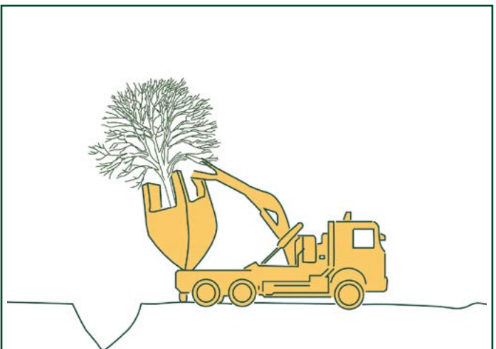
Figur 1 viser et prinsipp for flytting av små trær ved manuell oppgraving av treets jordklump, og bruk av gravemaskin for løft og transport.
