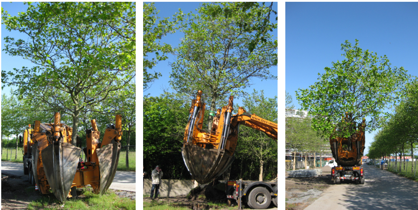
Bildeserie 2 viser flytting av et tre ved bruk av en treflyttemaskin, også kalt trespade (Foto: Johan Östberg).
