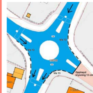
Figur 5.11: Rundkjøring med opphøyde krysningspunkter og/eller hevede armer (Figur: [5.5])
