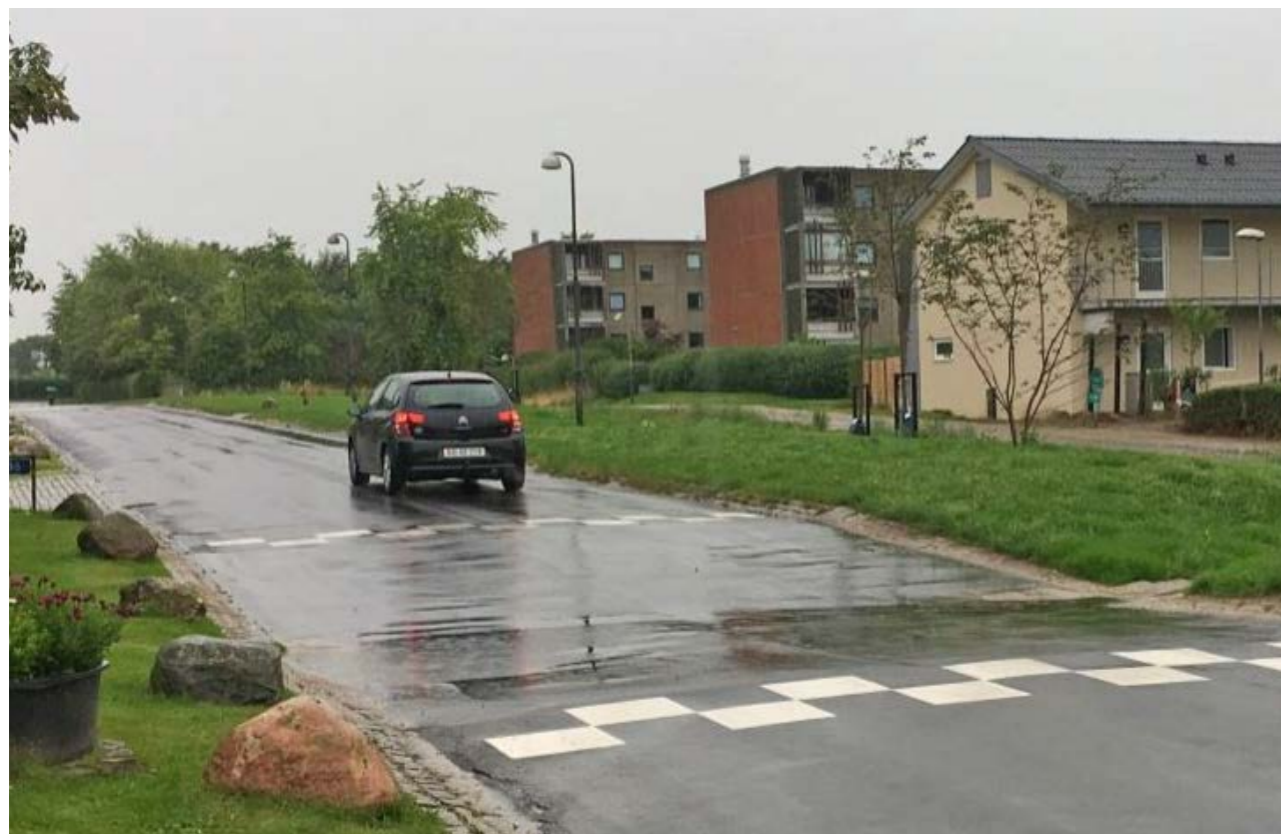
Bilde 4.11: Omvendt fartshump/fartsdump i Kokkedal, Danmark (Foto: Rambøll)
