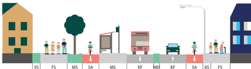
FIGUR 3-1 Eksempel på gatens oppbygning
