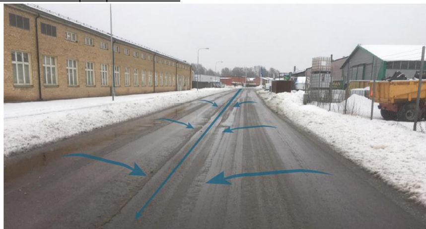
Figur 14: V-profil, Sagverksgatan, Karlstad (Figur: [26]).
