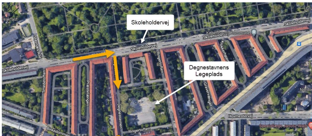
Figur 21: Transportretning av skybruddsvannet til fordrøiningstiltaket i Degnestavnens Legeplads (Foto: Google, bearbejdet av Rambøll).
