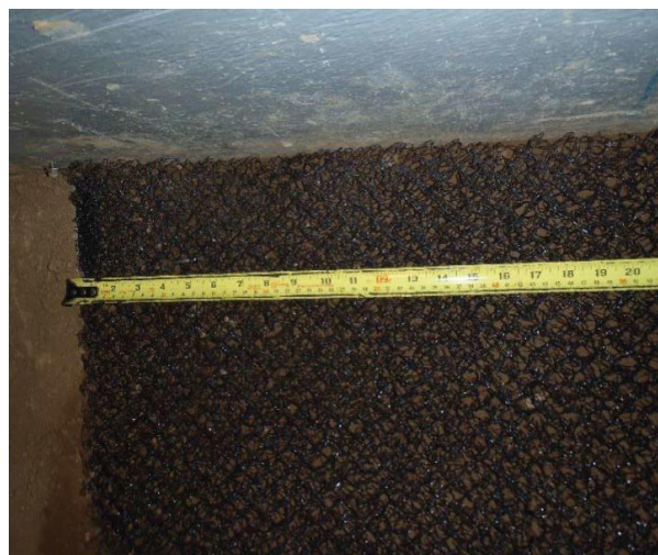
Figur 31: Alternativ 2 – Torvforsterket matte (syntetisk) med fiberarmert matte under (Figur: [36]).
