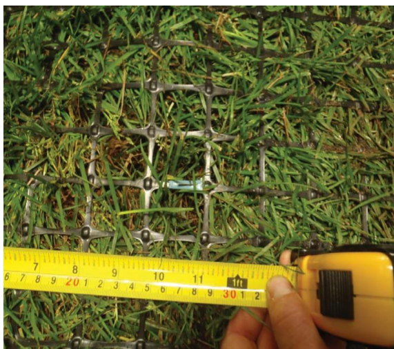
Figur 30: Alternativ 1 – geogitter over jorddekke (Figur: [36]).
