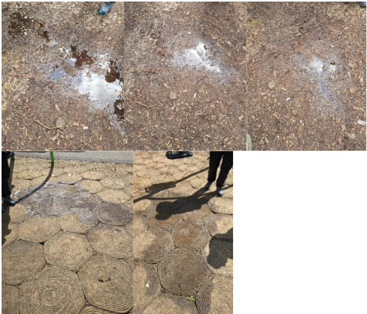
Figur 11 Test av permeabilitet og drenering i Bergen på slutten av testperioden. Bilder øverst viser LekeBARK, og bilder nederst viser Baremark. Foto: Lekeplassinspektøren
