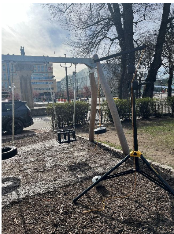
Figur 10 Bilde fra gjennomføring av HIC-test på innovasjonsproduktet LekeBARK på Christian Frederiks plass. Foto: Lekeplassinspektøren
