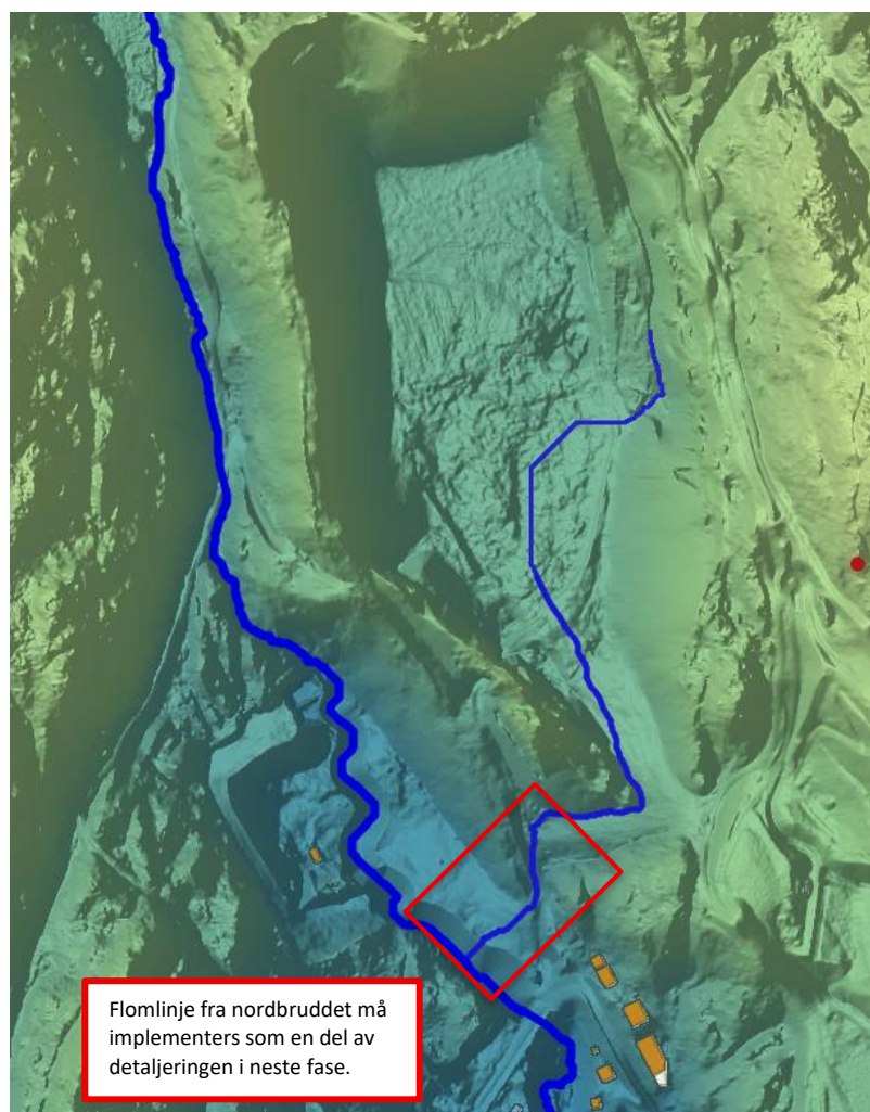
Figur 5-7. Flomlinje fra nordbruddet ned i bekken. Nedbørfeltet er ca. 0,35 km 2 . Behov for tilpasning av flomlinje. Må hensynta fase og forventet avrenningsmønster i nordbruddet ved utarbeidelse av bekkeløpet. Kilde: Scalgo Live og Multiconsult.
