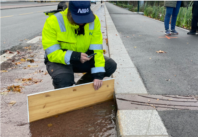
Figur 1. Innløpsrista i fortauskanten var i utgangspunktet tilstoppet av sand etter gatefeing og annet rusk som følger gatevannet (høyre bilde). Selv etter rensing måtte en midlertidig barriere settes opp for å lede vann til anlegget under et forsøk for å teste kapasiteten på regnbedet.
