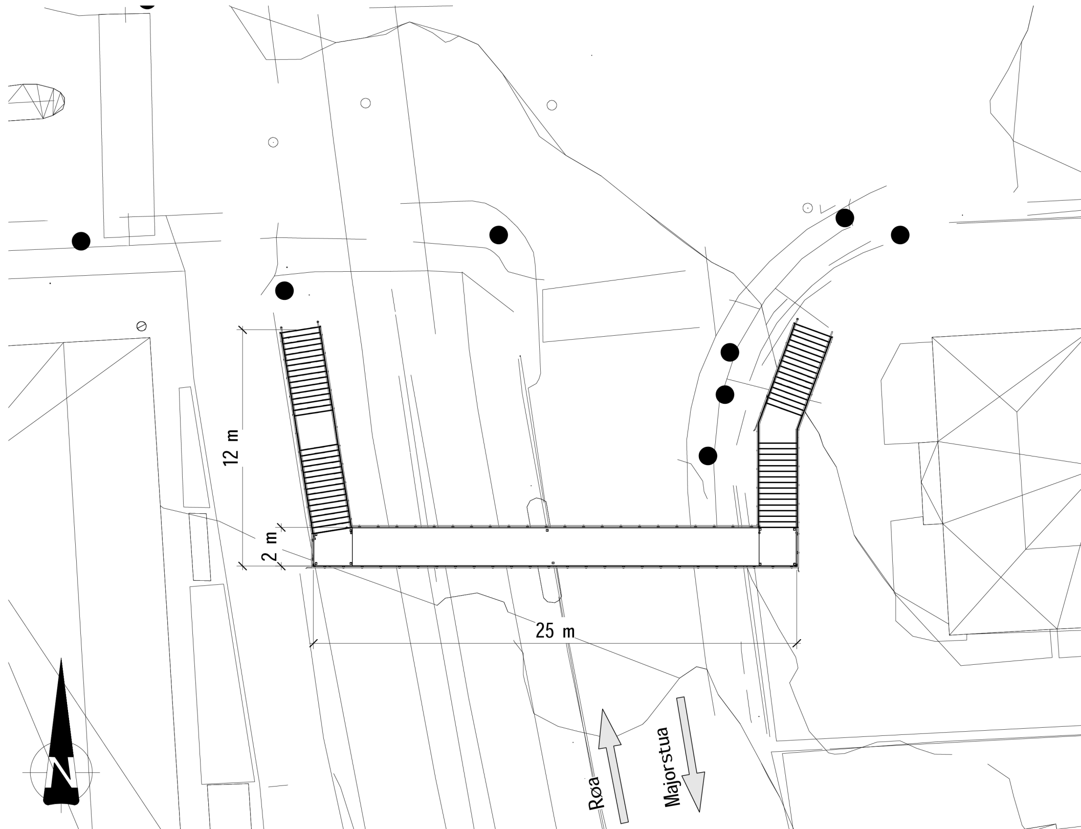
Overgangsbru med trapper Plan 25.08.2022
