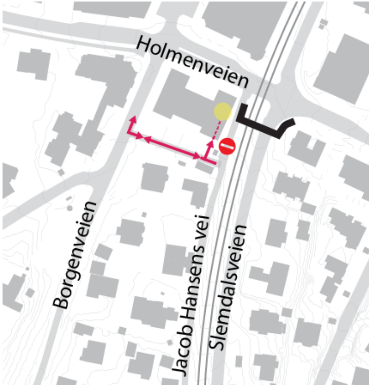
Figur 3-8: Varelevering alternativ 2, inn- og utkjøring fra Borgenveien
