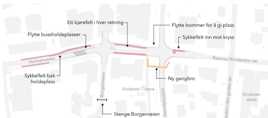
Figur 6-3 Konsept 4a gjennom Vinderen-krysset
