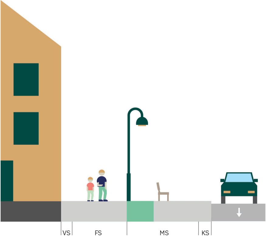
Figur 18.2 Belysningsmast plassert mellom ferdselssonen og møbleringssonen
