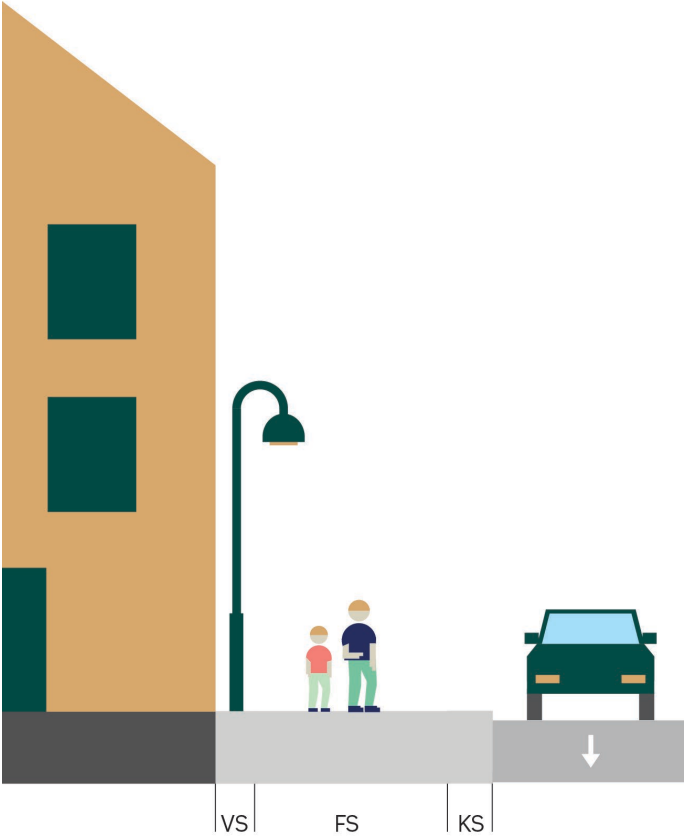
Figur 18.1 Belysningsmast plassert i veggsonen
