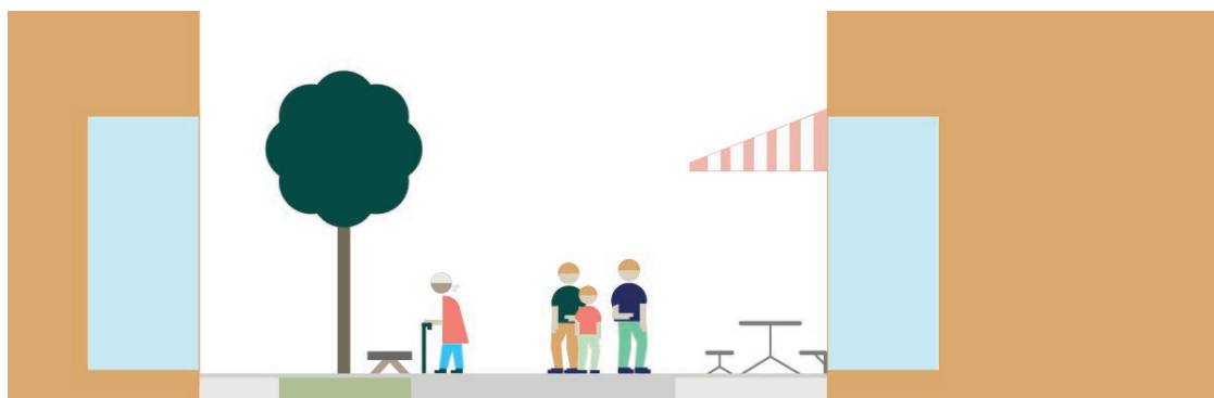
Figur 2.2 Generelt snitt av en gågate med midtstilt ferdselssone og møbleringssoner mot fasader.
