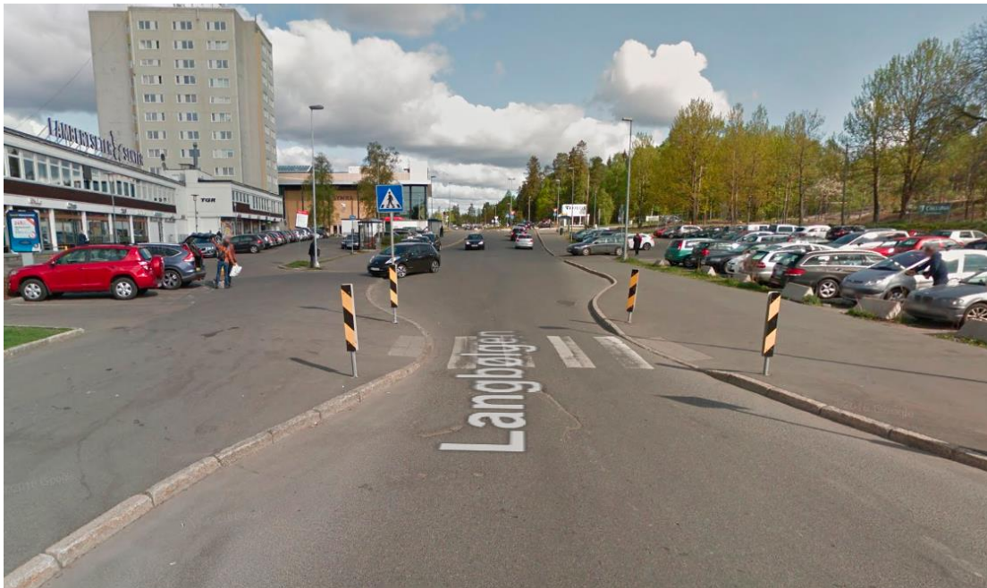
Bilde 1: Innsnevring til ett felt, Lambertseter (Foto: Google)
