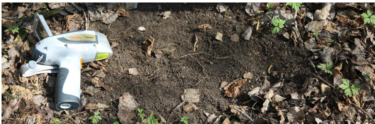
Foto 7. XRF måling på overflatejord i lauvskogen øst for banen (PD1). Jorda er sterkt forurensset av bly.
