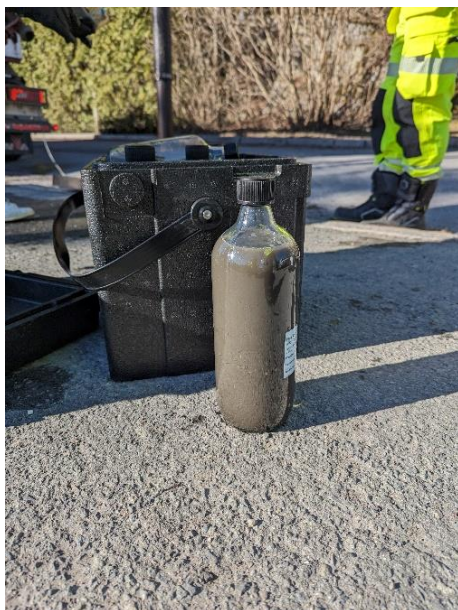
Figur 4-2 Vannprøve etter tilbakeføring av spylevann.
