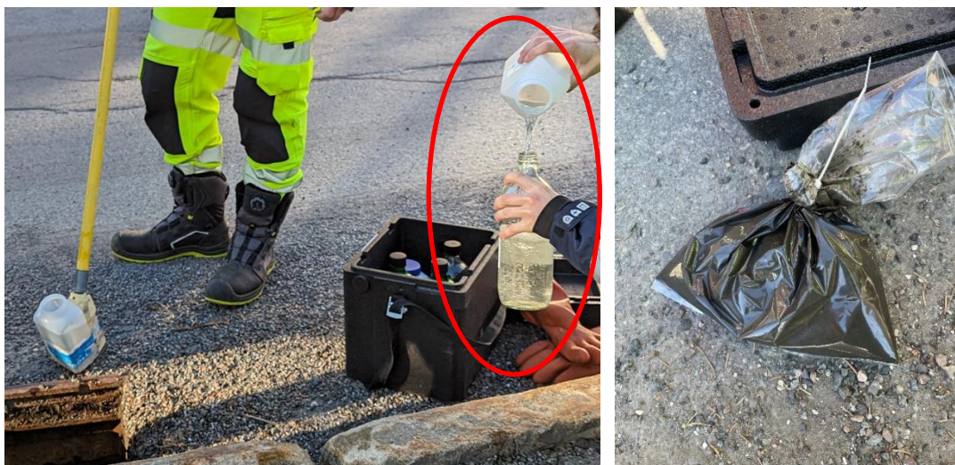
Figur 4-1 Til venstre: Vannprøvetaking før spyling. Vannet er tydelig klart. Til høyre: Sedimentprøve.
