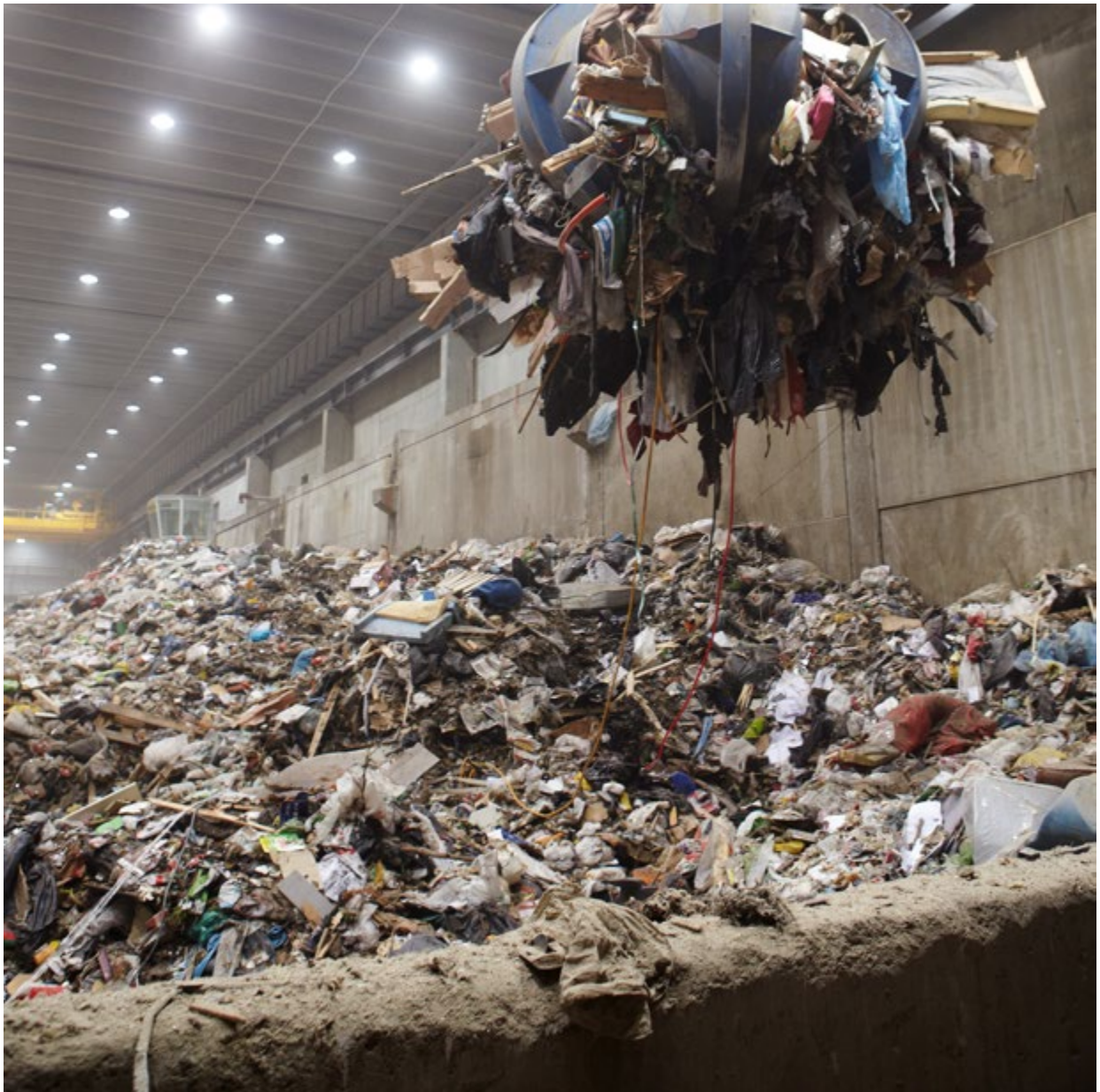
Etter at de grønne posene med matavfall og de blå posene med plast er sortert ut, brennes resten av husholdningsavfallet på anlegget på Klemetsrud. Energien utnyttes til fjernvarme. Foto: Fortum Oslo Varme
