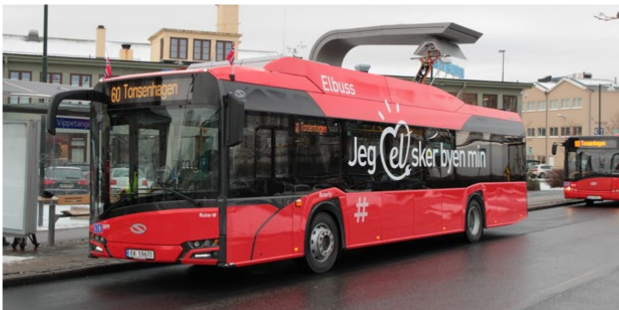
60-bussen lades via pantograf på Vippetangen. Foto: Øystein Dahl Johansen/Ruter
