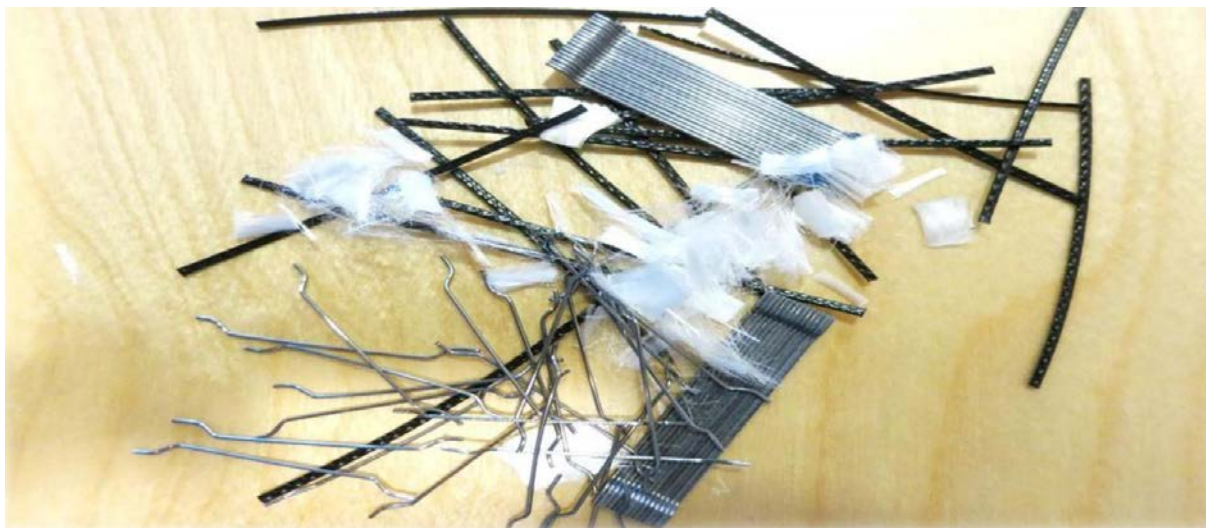
Figur 5 Plast- og stålfiber til tunnelsikring og mikro-PP-fiber til brannsikring (Likhosherskaya & Nyembwe, 2012)
