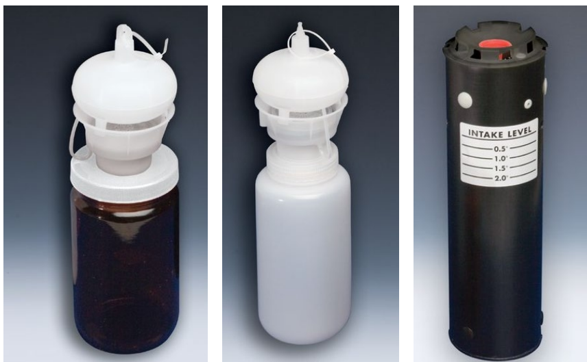
Figur 13. Passiv vannprøvetager fra Nalgene som består av en flaske i glass til organiske stoffer (bilde til venstre) og flaske en i plast til uorganiske stoffer (bilde i midten). Flaskene kan plasseres i en egen beholder slik at de er mer beskyttet (bilde til høyre). Prøvebeholderne kan henges i avløpskummer, graves ned i flukt med bakken eller plasseres stående i kummer og bassenger. Flaskene er utstyrt med egen selvlukkermekanisme når flasken er fylt opp med vann (kilde: https://www.thermofisher.com/order/catalog/product/1100-1000#/1100-1000 ).
