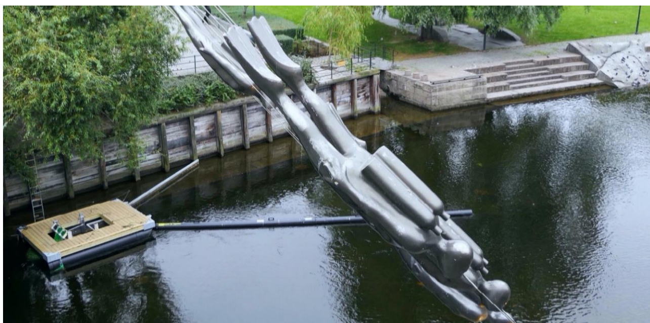
Figur 1: TrashTrawl med ledelensene og oppsamlingsnett plassert i midten av flytebyggen. Sjøppelopsamleren er utplassert ved Vaterland i nedre del av Akerselva. (Foto: SpillTec).
