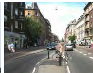
Oppbygde trafikkøyer gjør det mulig å krysse gaten i flere etapper. København, Danmark.
