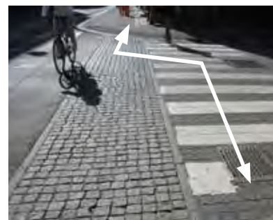
Overgangen blir utydelig når ikke overgangsfeltet plasseres direkte som en forlengelse av fortauet. Nedre Slottsgate.
