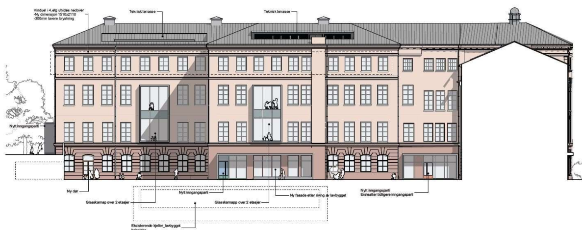
Figur 24: Fasade mot vest (gårdsrommet) viser blant annet etablering av ny fasade i 1. etasje etter riving av lavbygg, nye inngangspartier, glasskarnapper i bygningens 2. og 3. etasje og tekniske takbalkonger.
