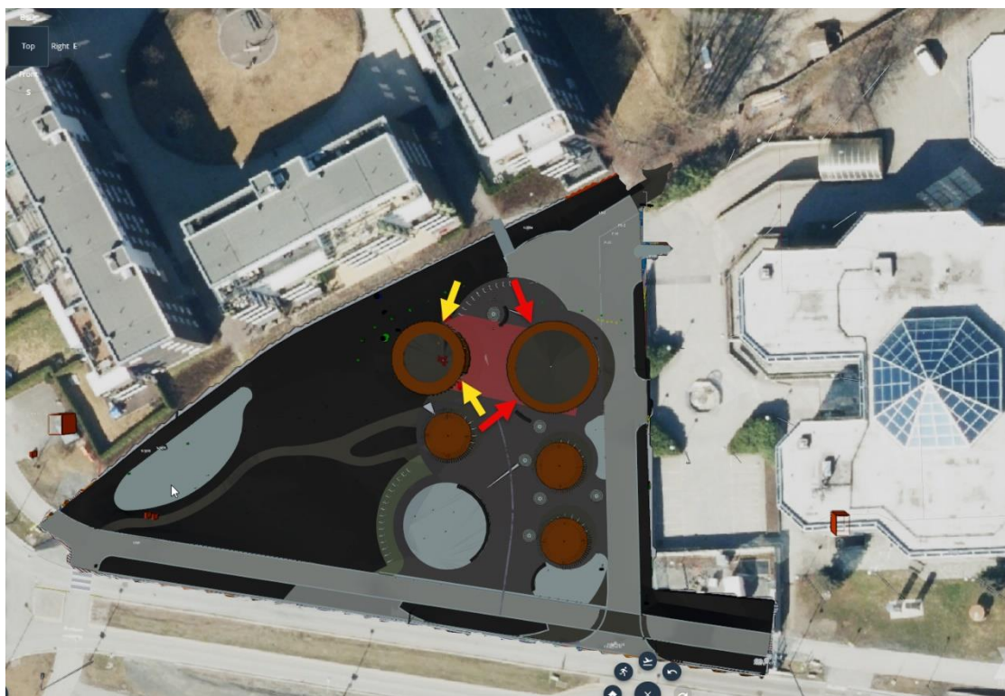
Figur 1-2: Innganger som skal sikres mot vanninntregning ved flom. T-banestasjonens innganger A er markert med røde piler. Innganger til teknisk bygg (rømning og beredskap/avfall) er markert med gule piler [1].
