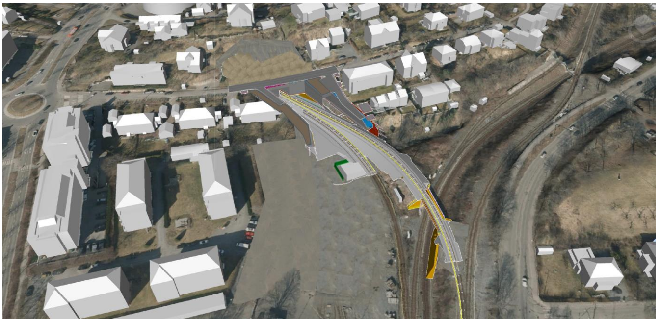
7 Reetablering av infrastruktur i området, tilbakeføring av vei over kulvert i Thaulows vei.
