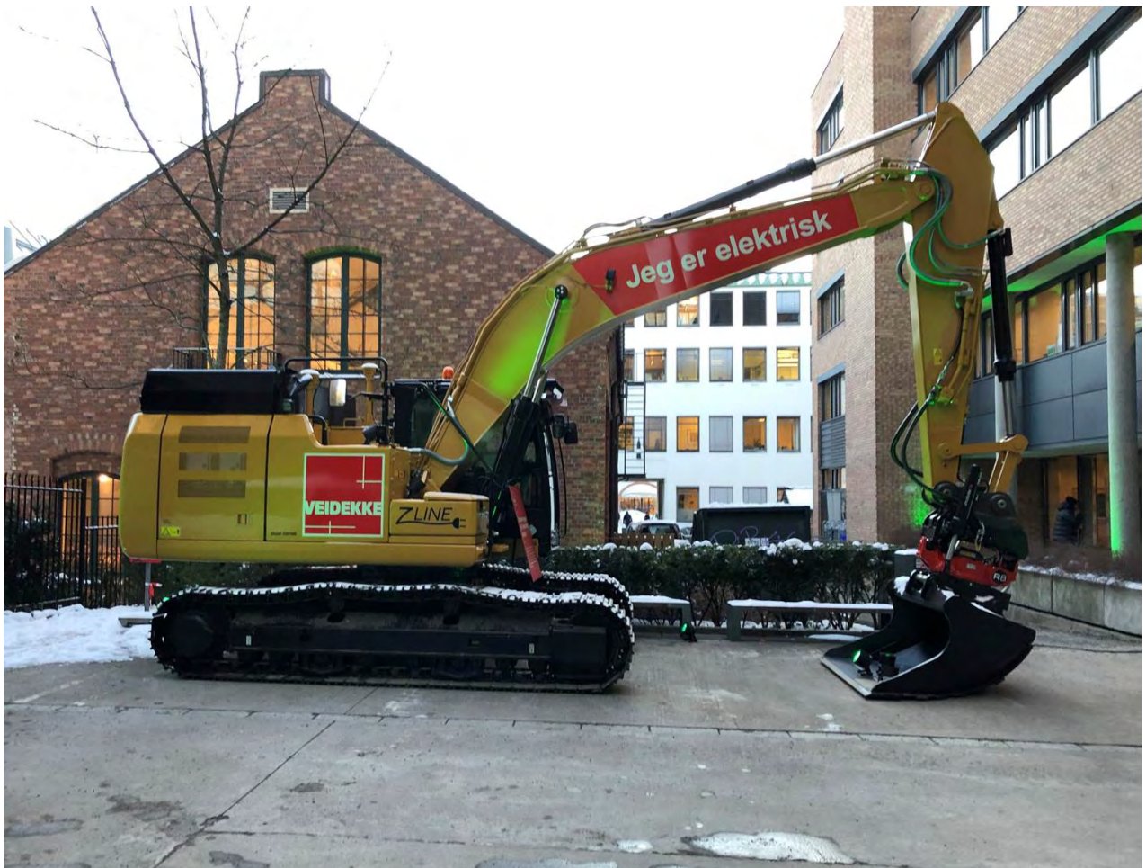
Elektrisk gravemaskin. (Foto: Tove Lauluten, FutureBuilt)
