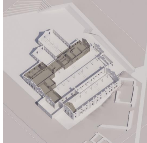
Illustrasjon 35 Bygget besto opprinnelig av åpne haller. Hallene er delt med søylerekker som bærer parallelle saltak Illustrasjon 36 I nyere tid er det etablert innvendige konstruksjoner for blant annet kontorfunksjoner, markert i grått
