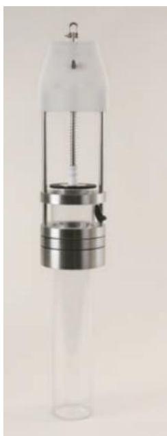
Figur 35. HTH-kjerneprøvetaker med plexiglassrør benyttet for prøvetaking av bunnsedimenter i bukta mellom Gressholmen og Rambergøya 17.09.2024 ( The HTH Gravity Corer | pylonex1 ).
