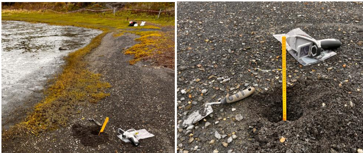
Figur 52 Undersøkelser av blykonsentrasjoner i forskjellige jorddybder ut mot vannet i den vestre bukta på Gressholmen (COWI)
