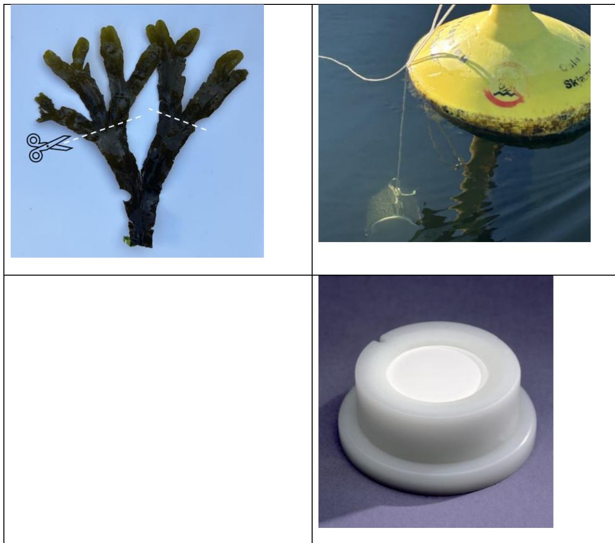
Figur 37. Innsamling av tang ( Fucus sarratus ), (venstre bilde) hvor de øvre skuddspissene klippes av for analyse. Høyre bilde, hvor DGT er plassert i stålbur hengende fra flytebøye på ca 50 cm vanndyp. DGT er vist i nedre høyre bilde. Innsamling og utplassering på Gressholmen 17.09.24.(COWI)
