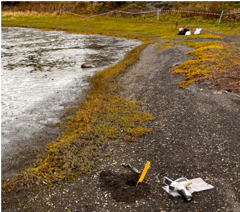
Figur 13 Prøvetaking på den vestre stranda inn i vika på Gressholmen. Her ble det også utført XRF-målinger i vertikalprofilen under terrengoverflaten (COWI).
