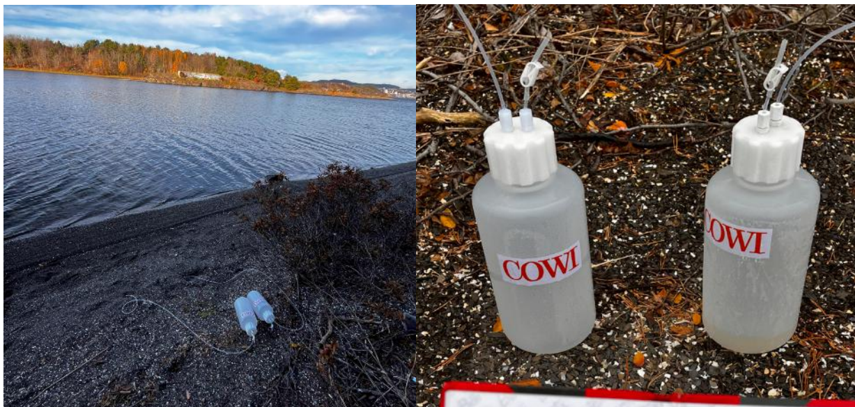
Figur 29 Bildet til venstre viser plassering av punktet Sonde 1. Det ble installert to vakuumsønder, en til hver flaske. Bildet til høyre viser mengde vann i flaskene ved vannprøvetakingen (COWI).
