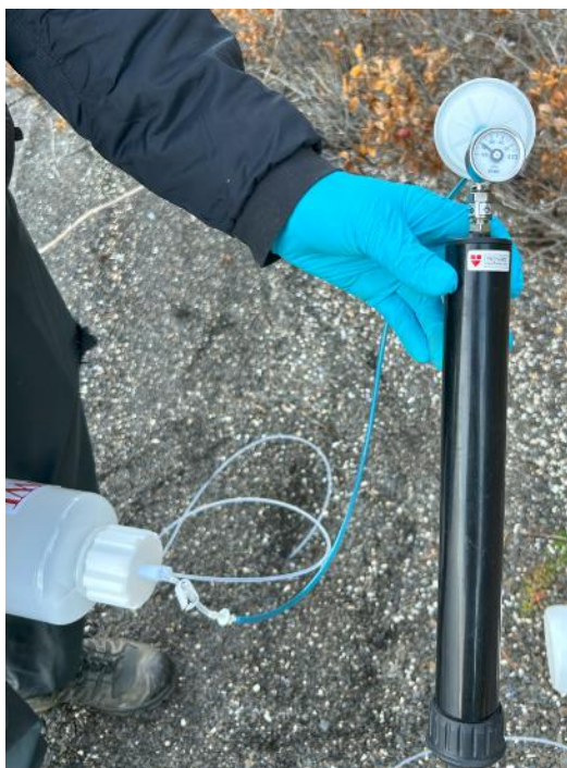
Figur 28 Flaskene tilknyttet sondene utplassert på Gressholmen og Rambergøya ble satt med et undertrykk på 0,8 bar (COWI)
