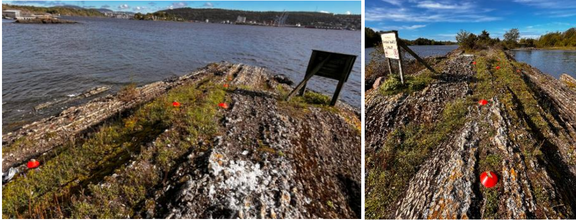
Figur 12 Bildene viser punkter (røde kjegler) med blykonsentrasjon over akseptkriteriene for et område som benyttes til bading på Gressholmen (COWI)
