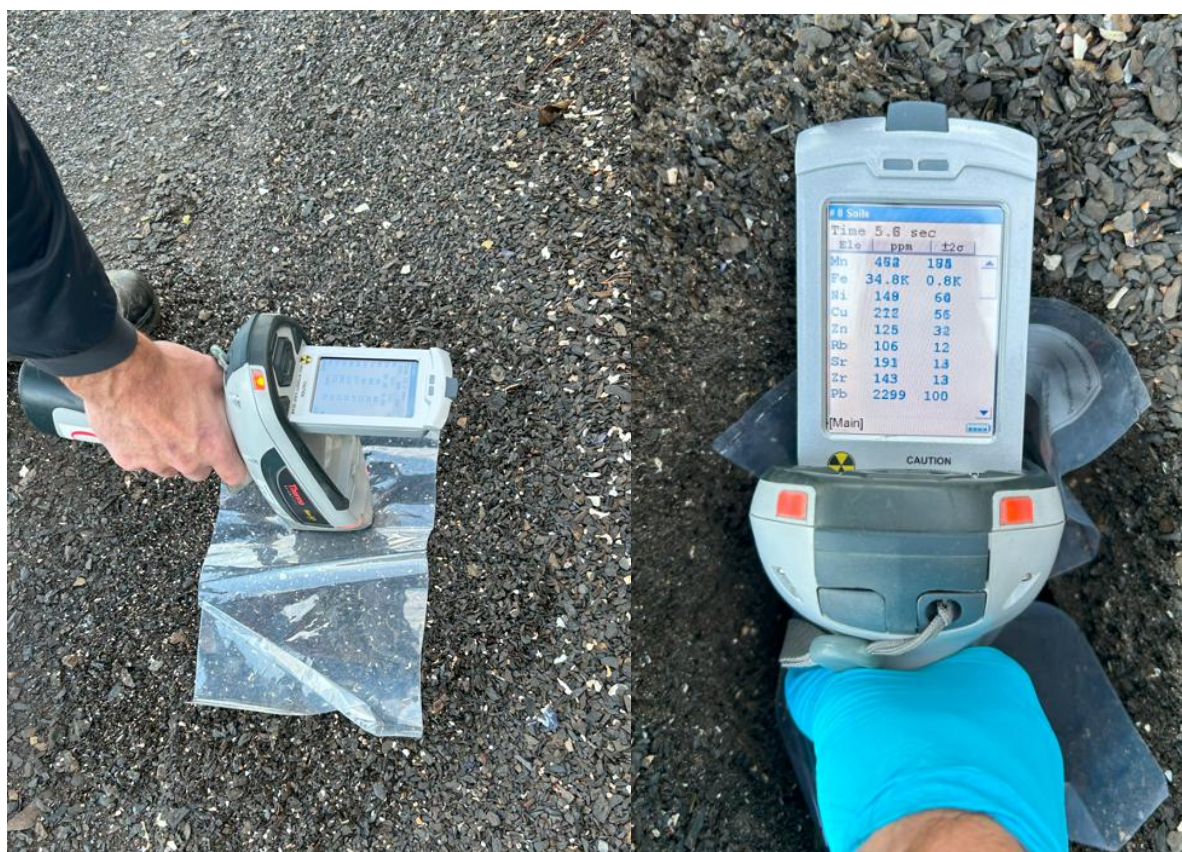
Figur 38 Bildene viser måling med XRF på stranda på Rambergøya. Venstre bilde i overflaten og høyre bilde i ca. 10 cm dybde (COWI)
