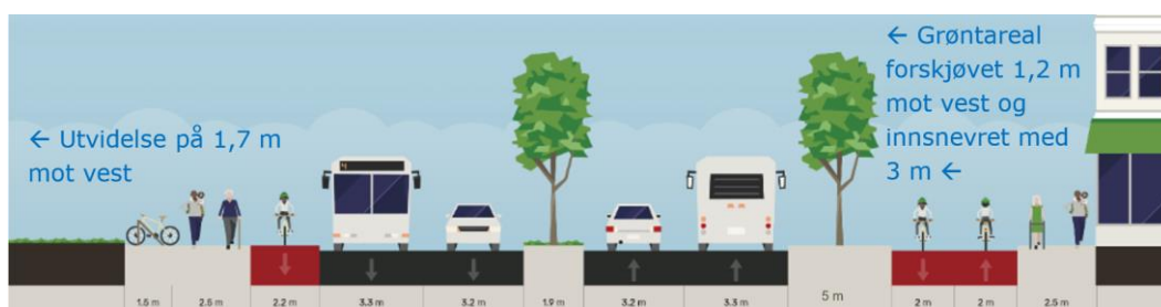
Figur 10 Snitt F, Alternativ 3-1. Utvidelsen og innsnevringen gjelder i forhold til dagens situasjon.
