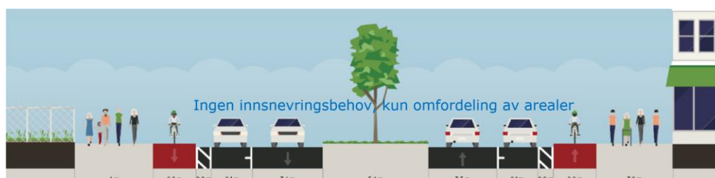
Figur 7 Snitt K, Alternativ 1 og parkering flyttet til utsiden.
