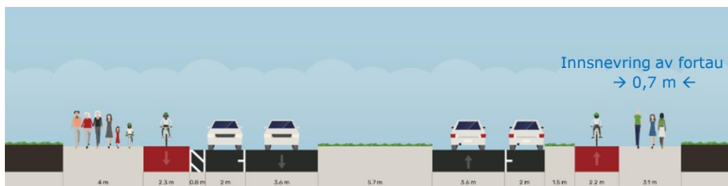
Figur 9 Snitt I, Alternativ 2 og parkering flyttet til utsiden. Innsnevringen gjelder i forhold til dagens situasjon.
