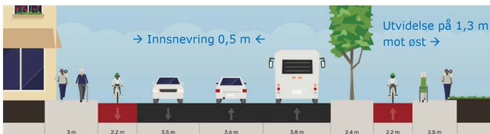
Figur 4 Snitt C, Alternativ 0+ og 1. Innsnevringen og utvidelsen gjelder i forhold til dagens situasjon.
