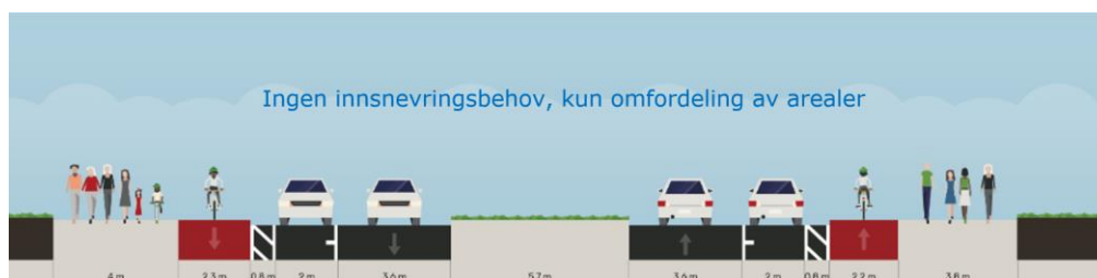
Figur 6 Snitt I, Alternativ 1 og parkering flyttet til utsiden.
