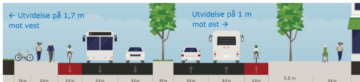
Figur 5 Snitt F, Alternativ 0+ og 1. Utvidelsene gjelder i forhold til dagens situasjon.
