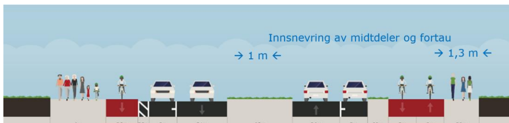
Figur 11 Snitt I, Alternativ 3-1. Innsnevringen gjelder i forhold til dagens situasjon.
