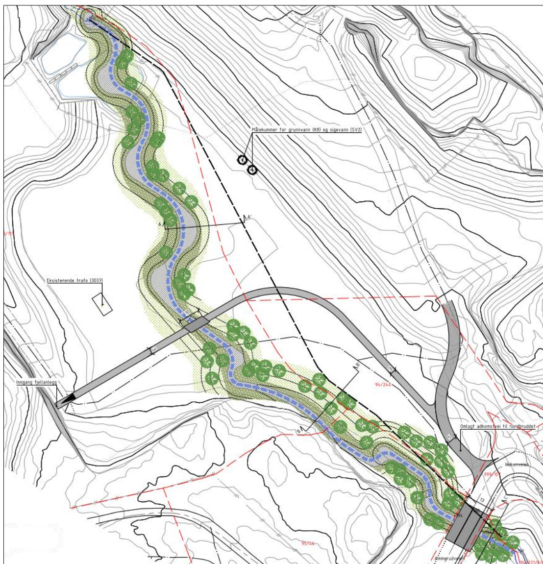
Figur 1-2. Utsnitt fra landskapsplanen som viser den foreslåtte traseen for bekkeåpningen i mulighetsstudien. Der bekkeåpningen krysser Ammerudveien anbefales det å etablere en bru.
