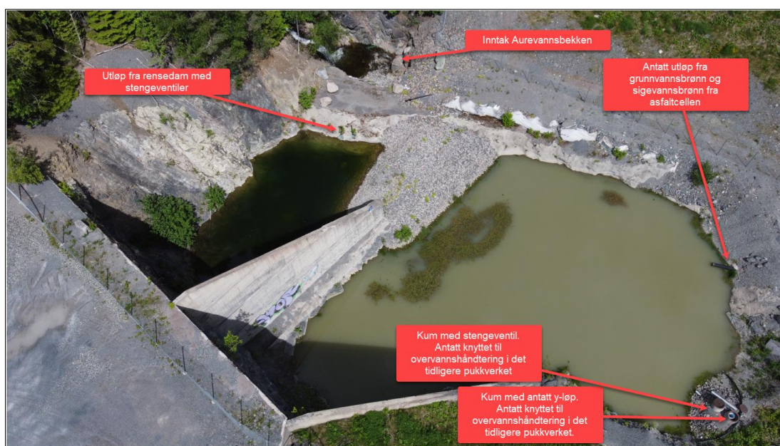
Figur 2-9. Dronebilde av rensedammen tatt 13.06.2022. Kumarrangement som antas å være knyttet til overvannshåndteringen i det tidligere pukkverket nederst i høyre hjørne, og antatt utløp for sigevann og grunnvann fra asfaltcellen øverst i venstre hjørne.
