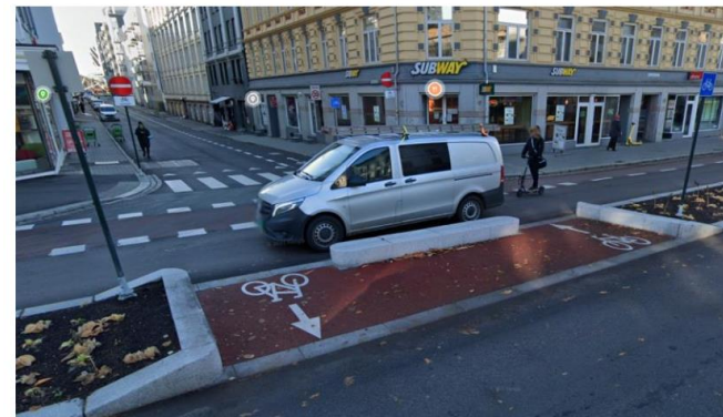
Figur 3-28: Sykkelsmett i Grønlandsleiret kryss Platous gate.
