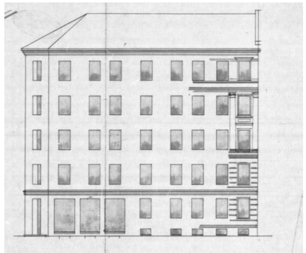
Fasadetegning av Maridalsveien 62 nå Lofotgata 4 fra 1899. Det var vanlig at arkitekten ikke tegnet inn hele fasaden på murgårdstegningene og heller ikke vindusutformingen (Plan- og bygningsetaten).
