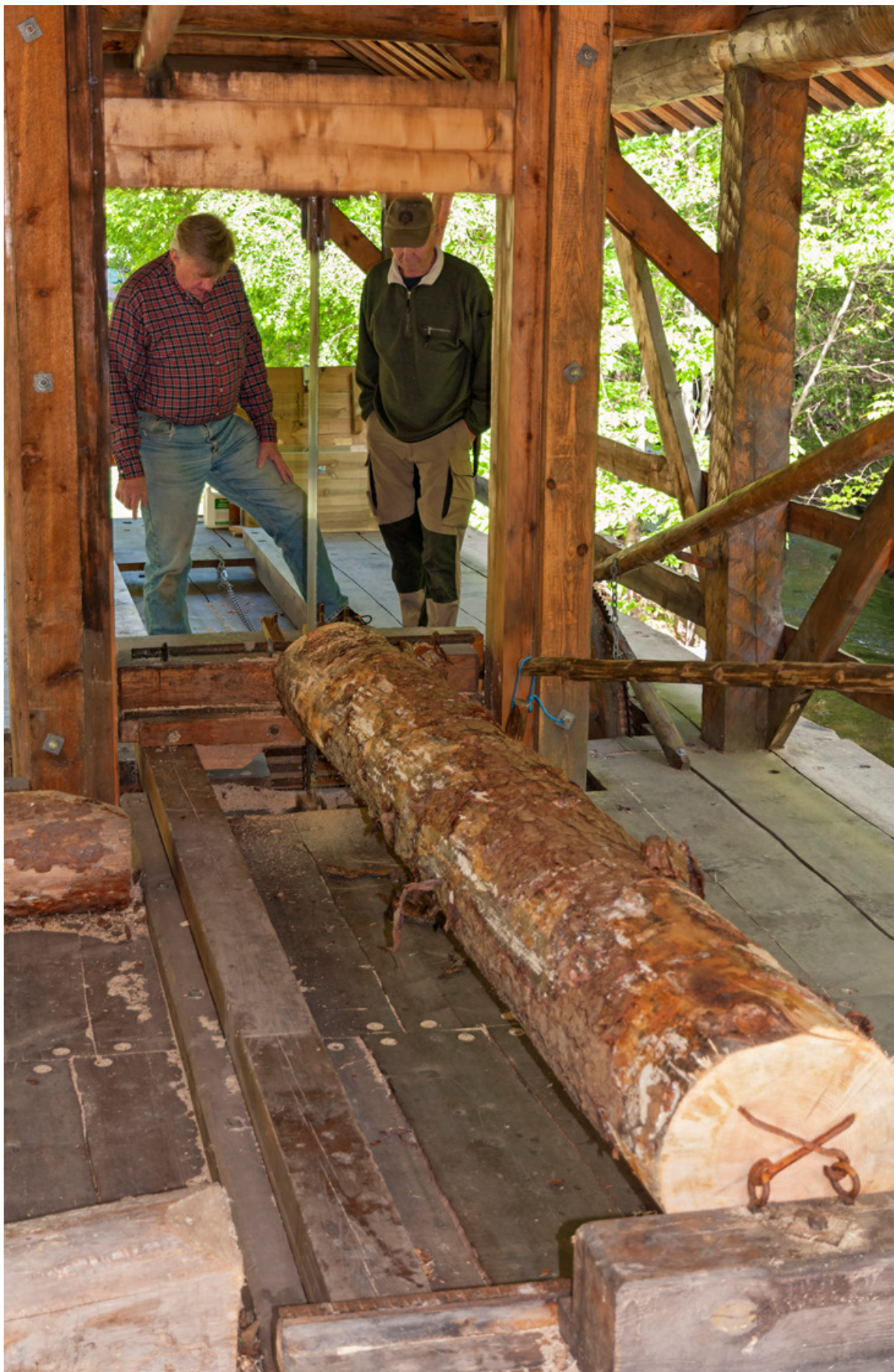
Oppgangssaga var en stor, teknisk nyvinning. Den la grunnlag for trelasteksport i stor stil. Her ser vi sagbenken i det rekonstruerte oppgangshuset i Gjersjøelva. (Foto: Bjørn Bekkelund/Norsk Skogmuseum).
