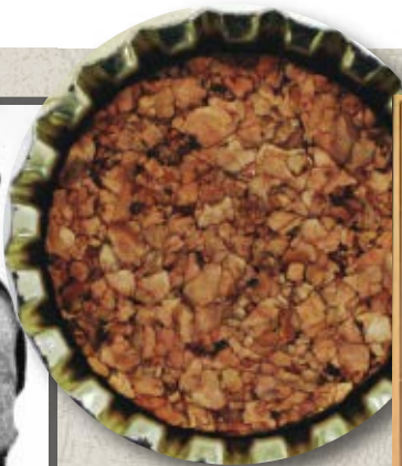
Crownkork fra 1947. Korken er omtrent som vi kjenner den i dag, bortsett fra at innsiden nå er belagt med gummi. NTM/A-1020/N/ L0014
